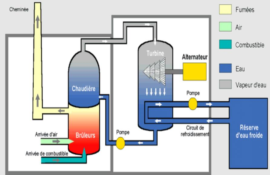
Fonctionnement d'une centrale thermique à charbon
